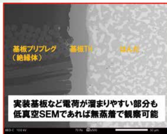
加速電圧：10 kV 倍率：x500 真空度：70Pa（低真空モード） 信号：反射電子
