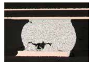
BGAクラックによる不良発生 例
