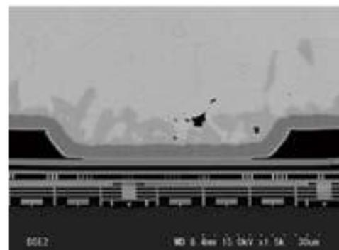
CPは、試料に遮蔽板を密着させ、遮蔽板から突き出した部分をArイオンビームで切削し断面を作製する方法です。CP法で用いるArイオンは2~6kVと低エネルギーであり、試料が複合材料であっても選択エッチングが起りにくく、イオンダメージの少ない平滑な断面が得られます。
