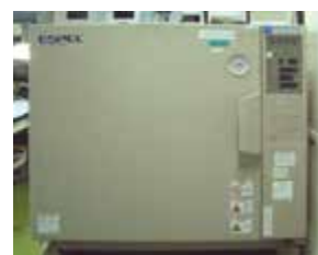
蒸気加圧試験槽 ( +105^{\circ}\text{C} ～ +140^{\circ}\text{C} 、75～100%)
