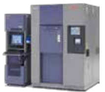
温度サイクル試験槽と 導体抵抗モニタシステム
