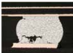
BGA クラックによる不良発生例
