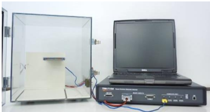
熱抵抗測定システム:TRM-7110A(当社開発システム)
