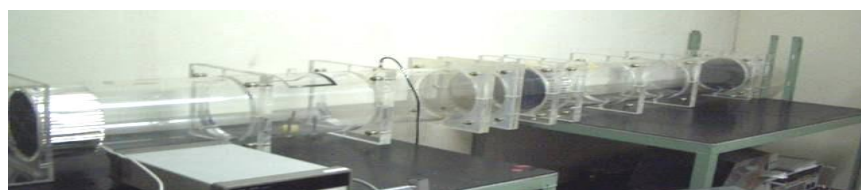
JEDEC規格対応_風速風洞
