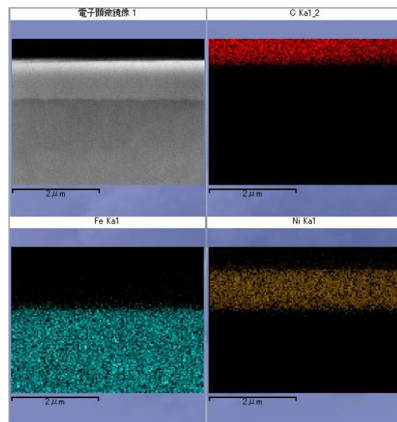
SEM観察による測長の結果、めっき厚は約 $1\mu\text{m}$ 、EDX分析の結果、めっき成分はニッケル(Ni)、ピン本体は鉄(Fe)であることが判明した。
